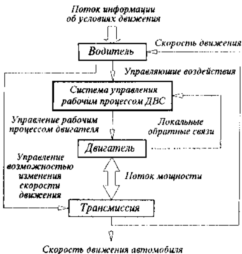
Рис. 1.2.1 Структура управления скоростью движения автомобиля
