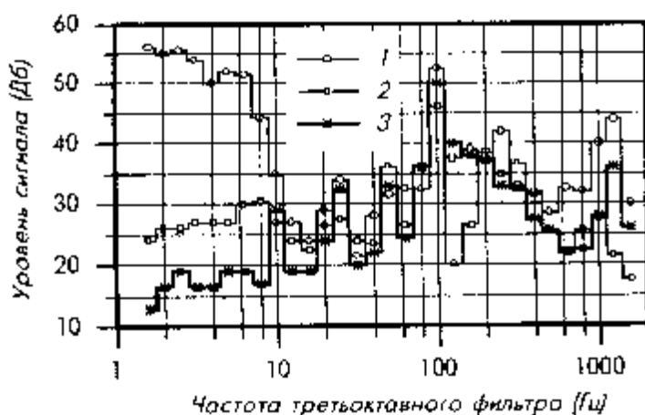
Рис. 3.8.3 Спектральная плотность колебаний абсолютного давления во впускной системе при открытии дроссельной заслонки (кривая 1), при закрытой дроссельной заслонке (кривая 2) и при открытой дроссельной заслонке (кривая 3) ( n=3000 \text{ мин}^{-1} , время открытия дроссельной заслонки 0.2 с, максимальные значения при времени усреднения 1/32с)
