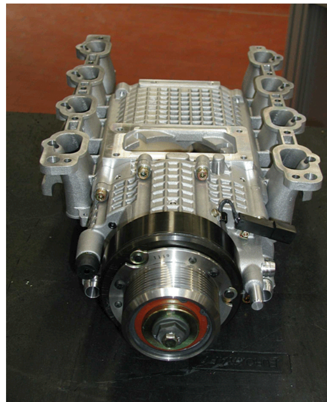
Винтовой нагнетатель M113
