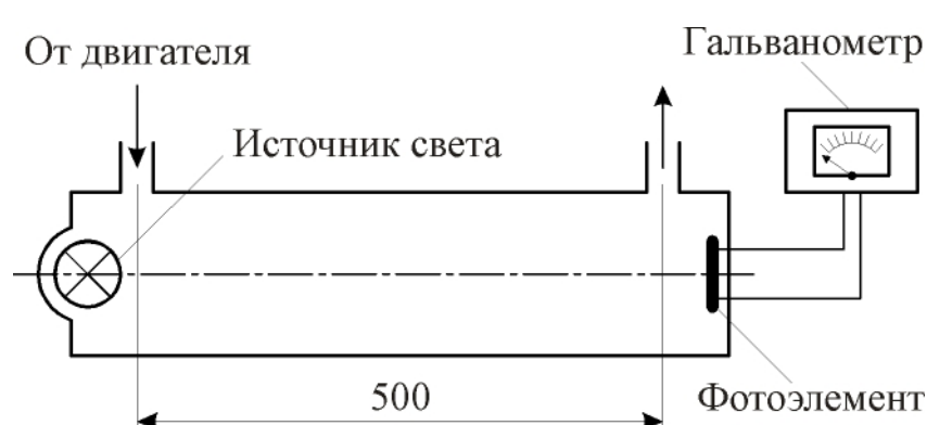
Рис. 10. 19. Схема фотоэлектрического дымомера
