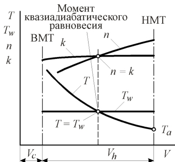
Рис. 3. 3. Схема изменения показателей, характеризующих процесс при сжатии РТ
